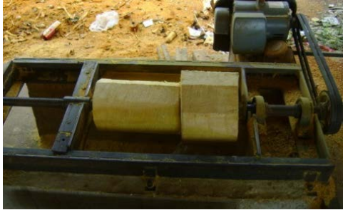
ภาพที่ ๘ การวางหุ่นทับบนแท่นกลิ้ง (ที่มา: พัทธราภรณ์ เอื้อจิตรเมศ, ๒๕๕๘)
